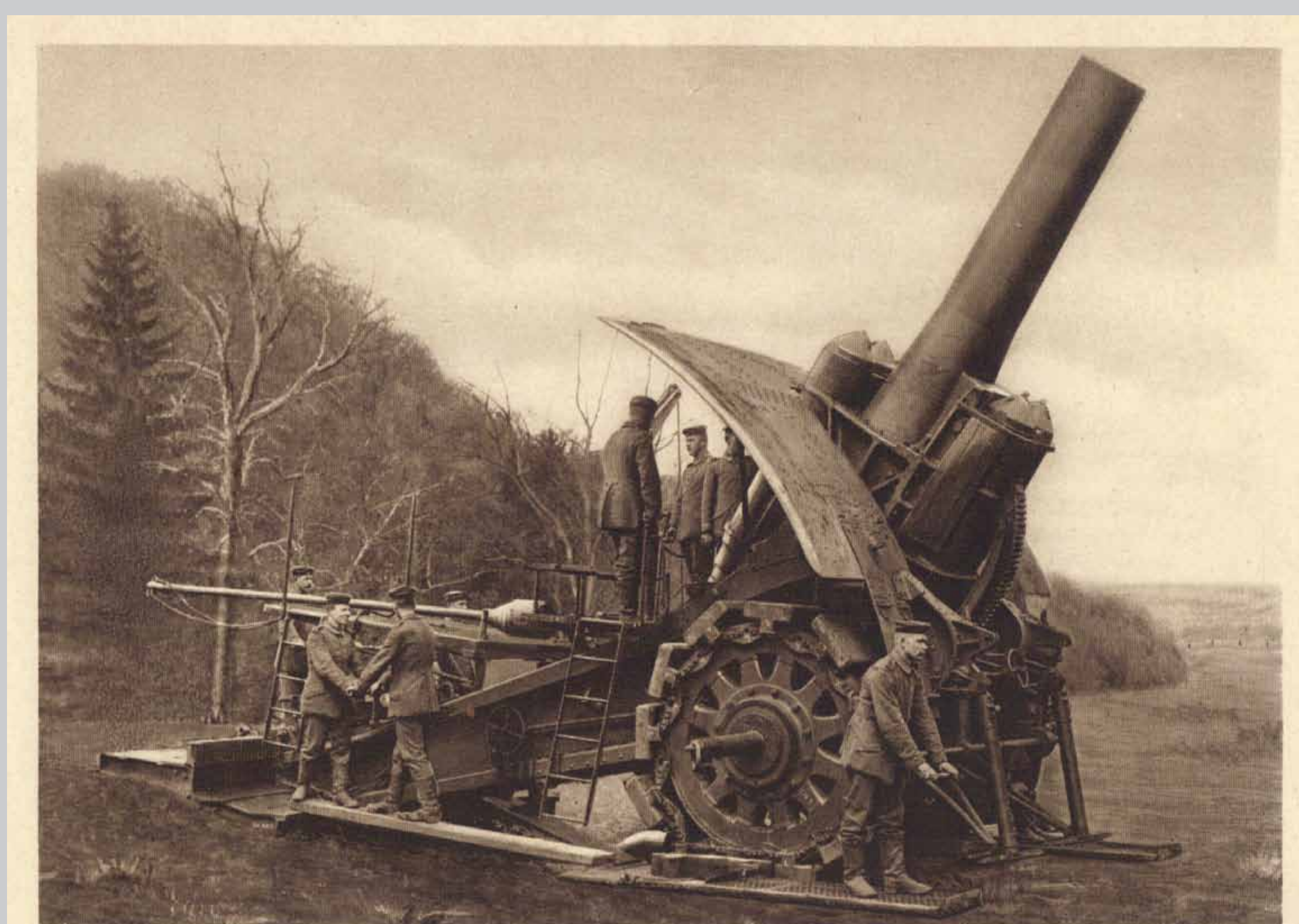
Ein 42 cm Mörser, dessen Verwendung bei Kriegsbeginn Aufsehen bei allen Mächten erregte. Das Gewicht eines Geschosses („dicke Berta“) beträgt 900 kg, die Schussweite ca. 10 km. Der 42 cm Mörser entstand gewissermaßen als Privatunternehmen der Firma Krupp durch das Verlangen des Generalstabes, dem eine unmittelbare Beeinflussung des Reichstages unterlag. Die Heeresleitung wollte ein Geschütz besitzen, das mit Sicherheit den Panzer- und Eisenbetonbauten der modernen Festungen gewachsen war.
